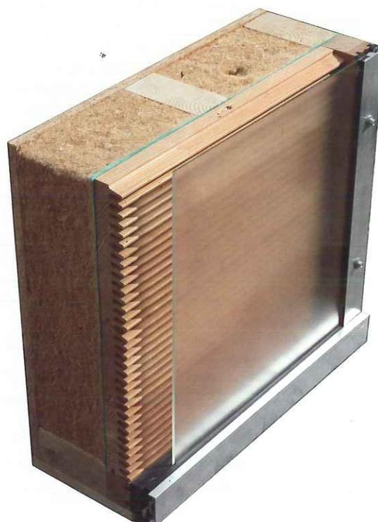
*Un élément de façade avec un cadre, un verre solaire, le bloc de lamelles – séparé, du verre par un espace libre – et les isolants.
