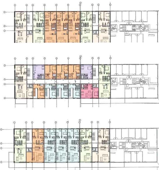
De bas en haut: plan des 1<sup>er</sup> et 4<sup>e</sup> étages, 2<sup>e</sup> et 5<sup>e</sup> étages avec rue intérieure, 3<sup>e</sup> et 6<sup>e</sup> étages.
